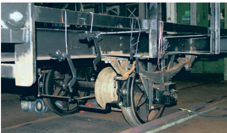
Am 14. Dezember 2013 waren die Schlosserarbeiten beinahe abgeschlossen und die Bremse bereits weitgehend montiert. Gut zu erkennen ist die Achstrommel für den Lichtmaschinenriemen.
