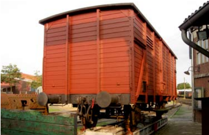
GW 1 wurde optisch ausgebessert und war für die Arbeiten in der Werkstatt auf einem Rollwagen verladen.
