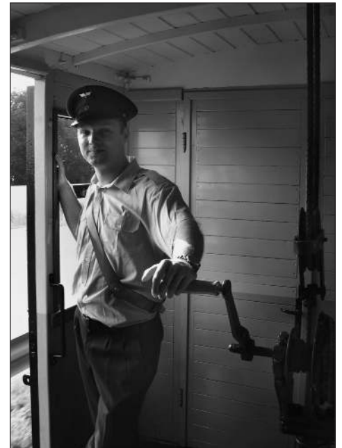
Oberhalb: Zugführer Mirko Fischer bremsbereit an der Haspel der Görlitzer Gewichtsbremse der FKB-Garnitur, 4. 7. 2009, Foto: Regine Meier
