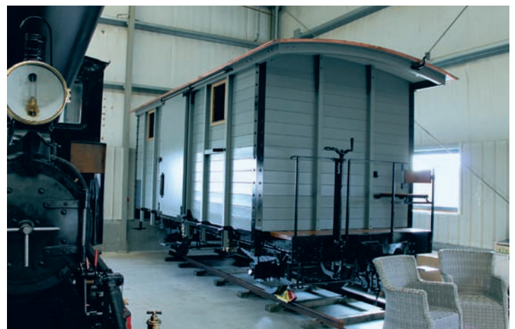
Von der Regenwalder Kleinbahn stammt dieser zweiachsige G-Wagen, der noch beschriftet werden muss. Im Unterschied zu Lenz-Fahrzeugen beim DEV wird hier auch die Farbgebung an das bis 1945 in Pommern gültige Farbschema angepasst. Zwei Fotos: Uwe Franz
