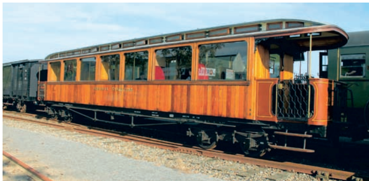
Im Gegenzug, der in Wognum-Nibbixwoud kreuzte, befand sich unter anderem dieser schöne holzverkleidete Personenwagen Nr. 22 (Görlitz 1904) der früheren Gooischen Stoomtram. Trotz Mittelpufferkupplung und geringer Breite war dieser Wagen stets normalspurig. 23. Oktober 2016, Foto: Uwe Franz
