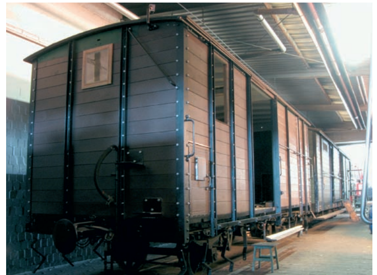
Inzwischen wurde Gepäckwagen Nr. 51 auch wieder mit Fenstern versehen und kann in Kürze lackiert werden. Bruchhausen-Vilsen 25. März 2017, Foto: DM
