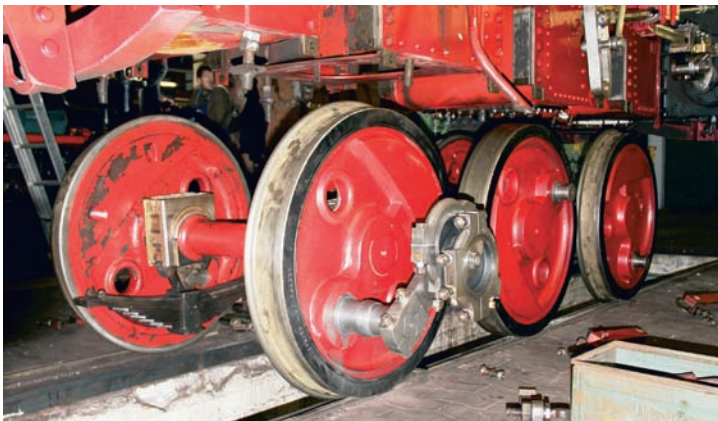
Die Achsen sind wieder mit Achslagern versehen, und der Rahmen der HOYA kann nach und nach auf die Achsen abgesenkt werden.
