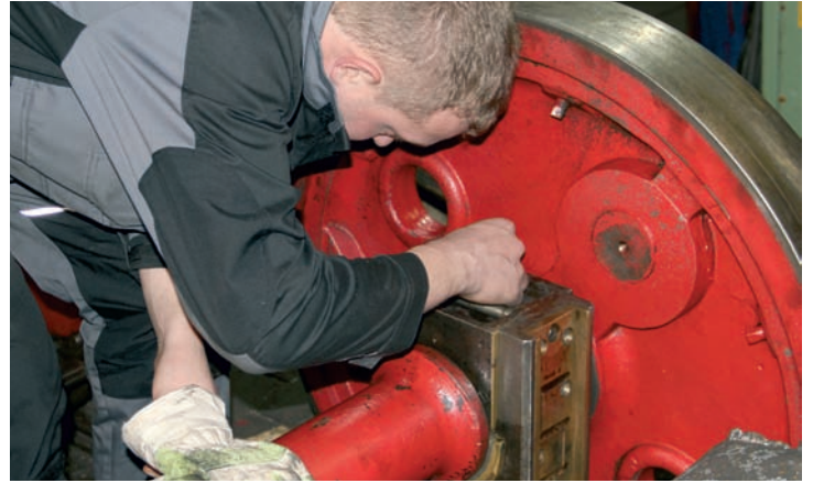
Die Achslager der HOYA waren neu ausgegossen worden und wurden hier von Matze (Matthias Jülke) wieder montiert.
