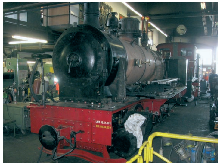
Wird langsam wieder montiert: Dampflokomotive HOYA in der Werkstatt in Bruchhausen-Vilsen. 25. März 2017, Foto: DM
