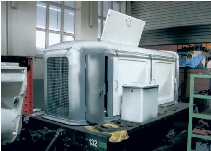
Die sandgestrahlte und grundierte Motorhaube der V 3, verladen auf Flachwagen 132. Bruchhausen-Vilsen, 25. März 2017, Foto: DM
