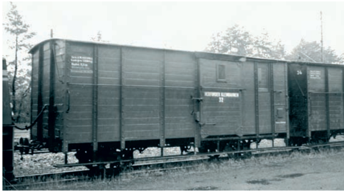
Der heutige DEV-Gepäckwagen Nr. 51 noch im Einsatz als Nr. 32 bei den Herforder Kleinbahnen. Bereits seit den 1930er Jahren fehlte ihm das Postabteil samt Klapptüren. Der rechts daneben erkennbare Nr. 34 besaß bereits ab Werk kein Postabteil, wie man an seinen gleichmäßiger verteilten Kastenprofilen leicht erkennen kann. Zuletzt wurden die Wagen als Lager- und Gerätewagen eingesetzt. Enger, Mai 1960, Foto: Harald Kindermann
