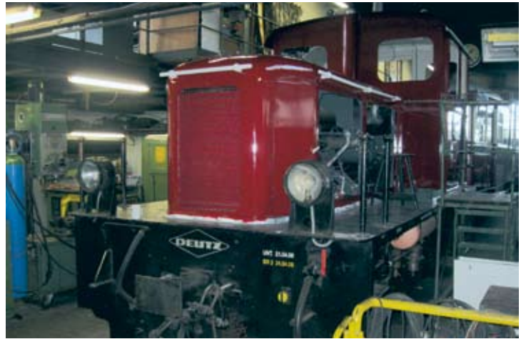
Diesellok V 3 erhält bereits den neuen Lack auf ihren Aufbauten in der Werkstatt.
