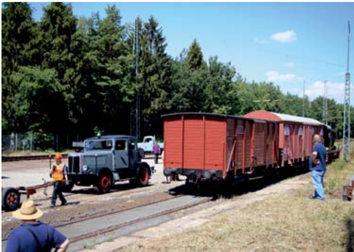
An der Ladestraße im Bahnhof Eystrup wurde rangiert: Der Güterwagen Gw 1 wird für den Culemeyer-Straßenroller bereitgestellt.
