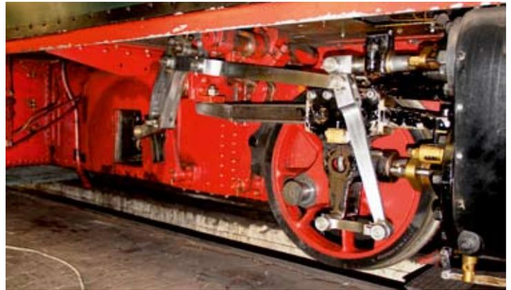
Für die Fahrwerksüberprüfung wurde Dampflok PLETTENBERG teilweise demontiert. Hier steht die vorübergehend einachsige Lok gerade in der Werkstatt.
