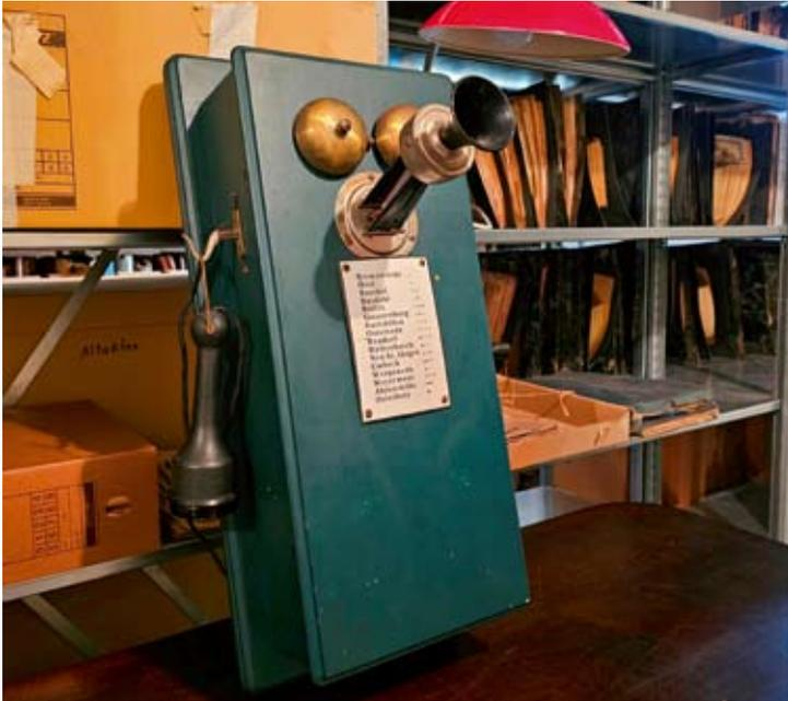
Im Rahmen einer Sachspende kam ein Streckenfernsprecher aus der Anfangszeit der Kleinbahn Bremervörde - Osterholz zum DEV. Die Rufzeichen wurden mit der Kurbel erzeugt, das kurze Rufzeichen (Punkt) wurde mit einer Kurbelumdrehung erzeugt, das lange (Strich) mit drei Kurbelumdrehungen, dazwischen immer eine Pause.
