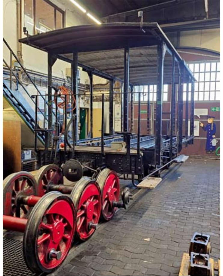
Ebenfalls in Hauptuntersuchung bzw. Restaurierung ist Güterwagen 144, dessen Verbletterung demontiert wurde und nun Rahmen und Aufbau entrostet werden. Davor zu sehen die Radsätze von HERMANN. 25.11.2023, zwei Fotos: RM
