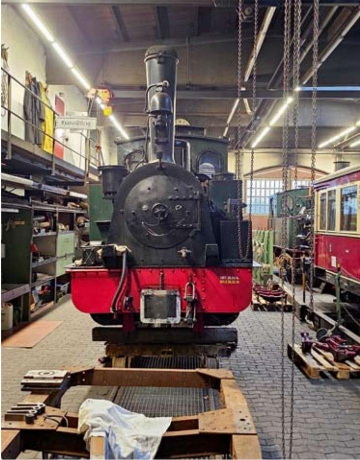
Seit dem Herbst ist HERMANN in Hauptuntersuchung. In der Werkstatt in Bruchhausen-Vilsen wurde sein Fahrwerk demontiert und die Lok danach ausgeacht. Die Stimmung ist gut, wie unschwer auf der Rauchkammer zu erkennen ist.
