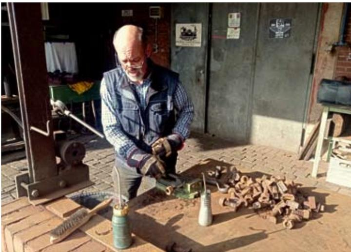
Auch Schienenbefestigungsmittel wie Hakenschrauben und Muttern wurden von Konrad Mans entrostet und somit für eine weitere Verwendung bei der Museums-Eisenbahn vorbereitet.
