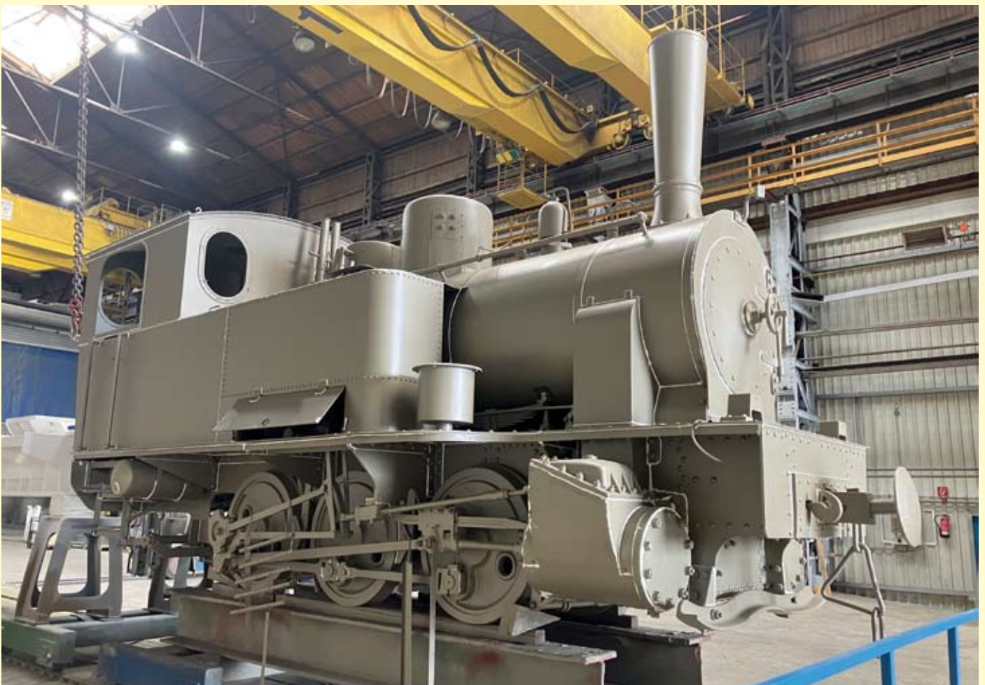
Die Restaurierungsarbeiten an der Denkmallokomotive BRUCHHAUSEN gehen voran. Nach Rost- und Farbfentfernung wurde bereits eine Grundierung aufgetragen. Bereits bei diesem Anstrich ist die Gleichmäßigkeit des Farbauftrages zu erkennen, die nur ein Fachbetrieb leisten kann. 26.03.2024, Foto: Stefan Trachsel
