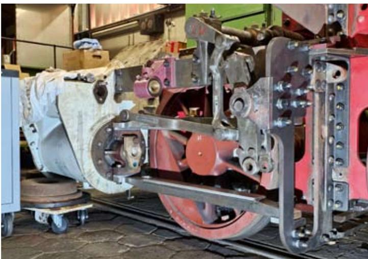
Noch einmal ein Blick auf die Mallet 7<sup>s</sup>: Das vordere linke Triebwerk im Montagezustand, die Gleitbahnen sind angepasst und vormontiert und mit jedem Arbeitstag gehen die Arbeiten ein Stück voran. Gerne beantworten die Aktiven um Thomas Meyer immer wieder Fragen zu einzelnen Komponenten oder stellen das Projekt Interessierten vor. 18.06.2024
