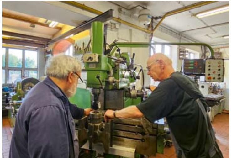
Immer donnerstags ist Werkstatttag für die Mallet-Crew. Stück für Stück geht die Restaurierung der 7<sup>s</sup> voran. Vor Anpassung und Einbau der Gleitbahnen werden die einzelnen Teile ganz genau vermessen. Bernhard Schulze und Thomas Meyer hatten hierzu einen Kreuzkopf eingespannt auf der Fräsbank. 23.05.2024
