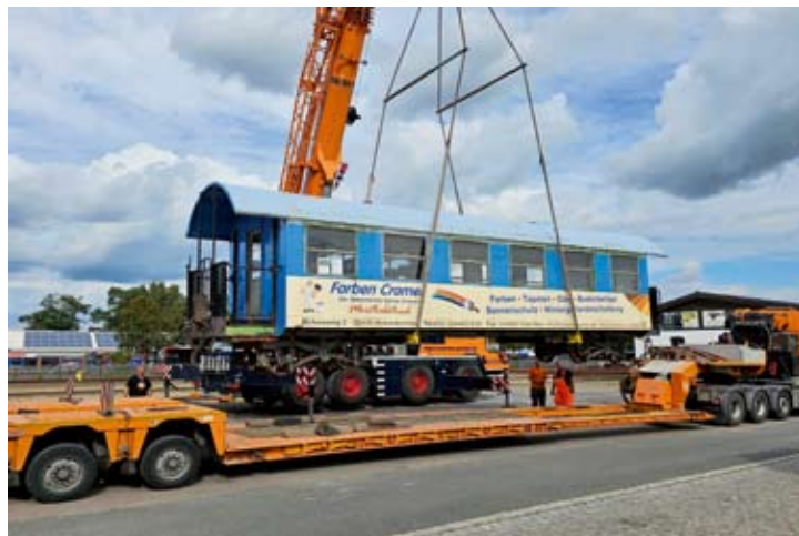
Der Personenwagen 63 109 hat eine bewegte Geschichte und mehrere Umbauten hinter sich. Nun ist er in Bruchhausen-Vilsen. Hier beim Abladen vom Straßentiefklärer mittels Autokran. 09.09.2024
