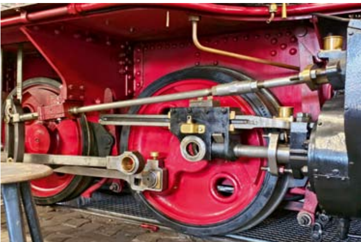
Ende Juli wurde intensiv an der HOYA gearbeitet, damit sie zu den „Tagen des Eisenbahnfreundes“ (TdE) eingesetzt werden konnte. Direkt nach Rückkehr des Radsatzes aus der Fachwerkstatt wurde dieser eingebaut und das Triebwerk montiert. 30.07.2024
