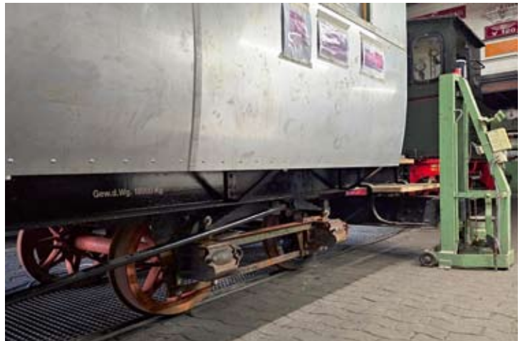
Anfang Oktober waren die erneuerten Drehgestelle dann unter dem Wagenkasten des Wagen 7 zu sehen. Mit nur wenig Anpassarbeiten gelang die „Hochzeit“, auch wenn die Drehgestelle später noch einmal zum Lackieren wieder demontiert werden müssen. 06.10.2024
