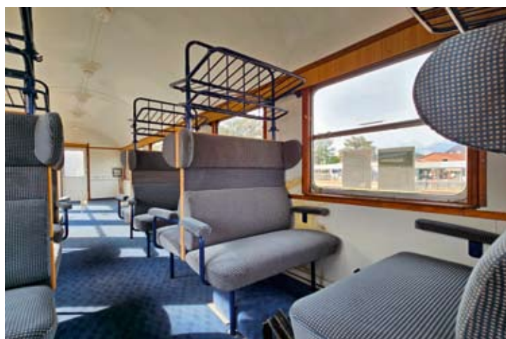
Der Wagenaufbau wurde 1959 in Anlehnung an das Umbauwagen-Programm der DB erneuert. Die teilweise noch vorhandene Originalbestuhlung stammt aus Bn- bzw. ByI-Wagen. Bruchhausen-Vilsen, 09.09.2024
