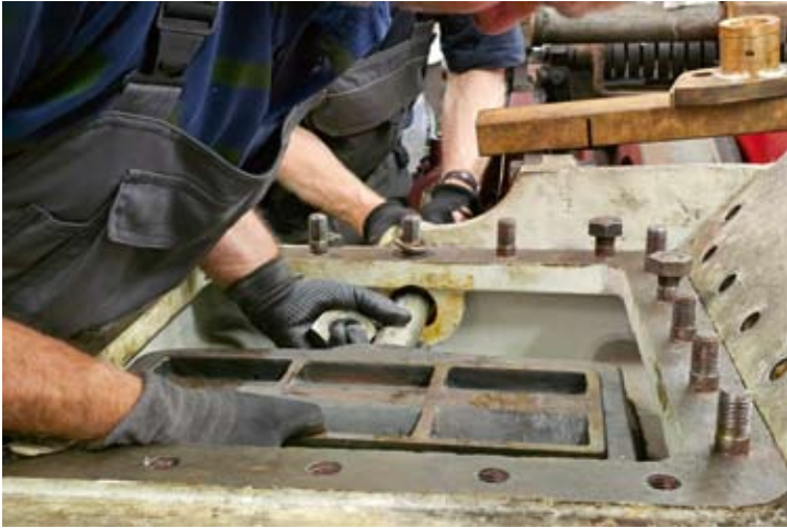
An der Mallet-Lok geht's Schritt für Schritt weiter, immer dienstags und donnerstags ist Mallet-Werkstatt-Tag. Mitte Juli wurden die Schieber an die Zylinder angepasst und eingebaut. Bernhard Schulze und Thomas Meyer sind dabei ein eingespieltes Team. 18.07.2024
