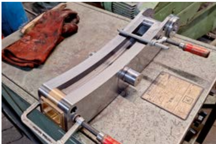
Manche Altteile der Malletlokomotive 7 s können aufgearbeitet und wiederverwendet werden, manche sind so verschlissen, dass sie neu gefertigt werden müssen zur Wiedereinbetriebnahme. Teile, die aus den Spendengeldern von Fachfirmen bezogen wurden: Eine vormontierte Taschenschwinge ...
