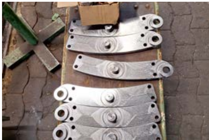
... und die anderen sechs neugefertigten Gleitsteine, die dann auch nach und nach auf ganz genaues Maß gebracht und montiert werden zur weiteren Vervollständigung des Triebwerkes der Mallet. Vielen Dank an dieser Stelle an die Spender! 09.06.2025, 2 Fotos: Uwe Franz.
