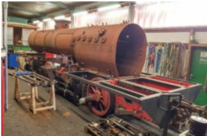
Die Mallet 7 s nähert sich mit dem inzwischen aufgesetzten Kessel wieder dem Erscheinungsbild einer Dampflokomotive. 23.02.2025, Foto: Christian Schröder-Thurau
