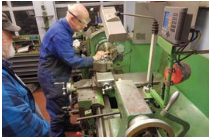
Zur Zeit liegt der Schwerpunkt in der Aufarbeitung des Fahrwerkes, Thomas Meyer fertigt neue Lagerbuchsen an der Drehmaschine. 23.02.2025, Foto: Christian Schröder-Thurau
