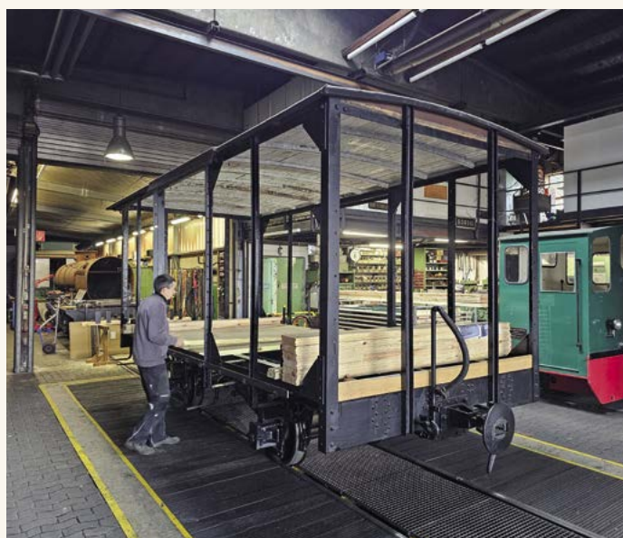
Kai sorgt für einen ebenen Holzfußboden im Wagen 144.
