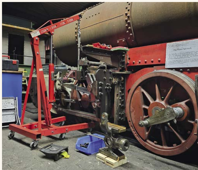
Montage der Gleitbahnen an der 7 s .
