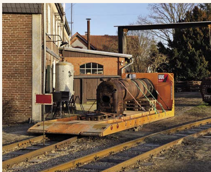
Der Kessel der Franzburg ist verladen zum Abtransport in die Kesselwerkstatt in Wetzlar.
