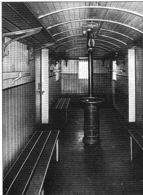
Die Fotos zeigen zwei Flachwagen, einen Werkstattwagen sowie einen für sowjetische Waldbahnen hergestellten Fakultativwagen mit 7 t Leermasse, 6 t Ladefähigkeit, 8.527 mm LüP, 2.450 mm Breite, 3.080 mm Höhe ü. SO, 4.500 mm Drehzapfenabstand, 1.020 mm Radstand in den Drehgestel-
